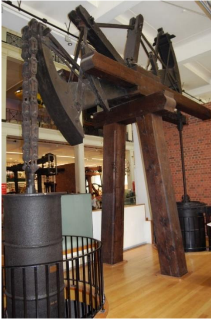
“Old Bess”, de pompmachine van James Watt met links de pomp en rechts de stoomcilinder.
