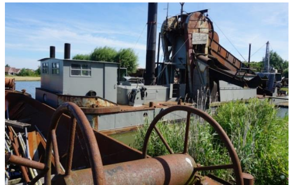
een van de stortgoten waar de bagger uit de emmers in terecht komt
