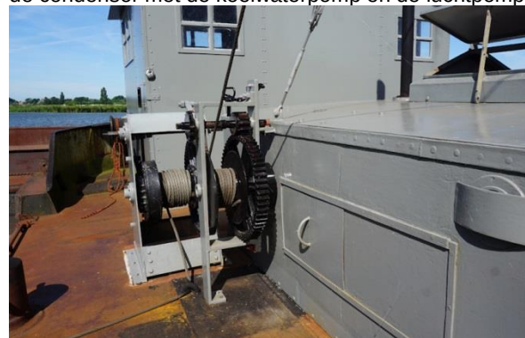
deze winch dient om de stortgoten op te hijsen
