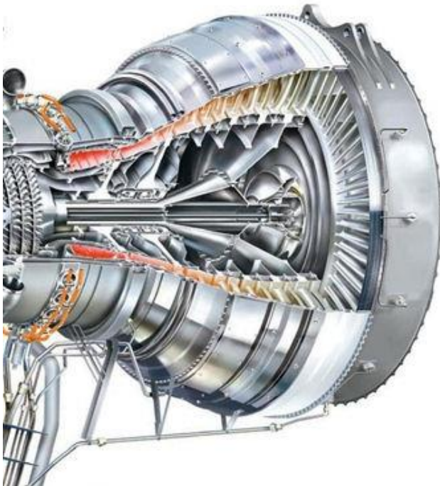
v.l.n.r.: hogedruktrap compressor, ringvormige verbrandingskamer en de turbine van de RR Trent 900
