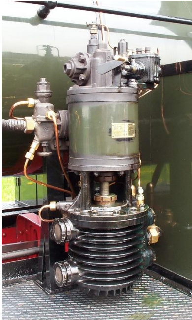
luchtpomp op de Hanomag van de stoomtram Hoorn-Medemblik
