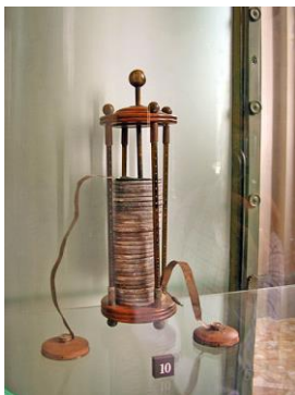
de eerste batterij van Alessandro Volta, uit 1800
