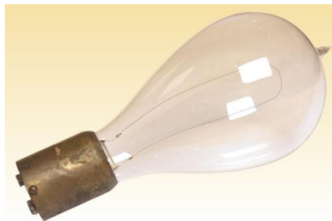
de kooldraadlamp (aan het tuutje zat een buisje waardoor de lucht uit de ballon werd gezogen; daarna werd het buisje dichtgesmolten en afgeknipt).
