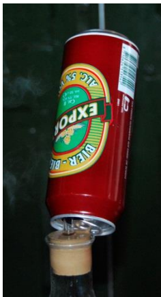
Het blikje wordt gevuld met stoom
